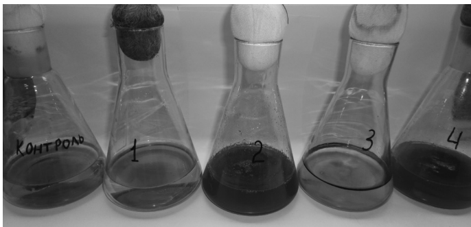
Рис. 3. Лабораторный эксперимент (нефть 5 мл/100 мл воды). 1 – дистиллированная вода + минеральные соли, 2 – дистиллированная вода + минеральные соли + биопрепарат «Универсал», 3 – дистиллированная вода + минеральные соли + микроводоросль Chlorella vulgaris , 4 – дистиллированная вода + минеральные соли + биопрепарат «Универсал» + микроводоросль Chlorella vulgaris
